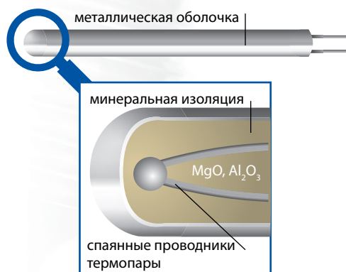
» Рис. 7 – Защищенное исполнение термопары
